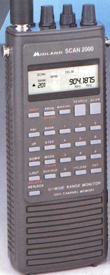
SCAN 2000 FREQUENZE: DA 0,1 A 2060MHz 200 CANALI DI FUNZIONAMENTO 1000- DEMODULA IN AM-FM-SBB
