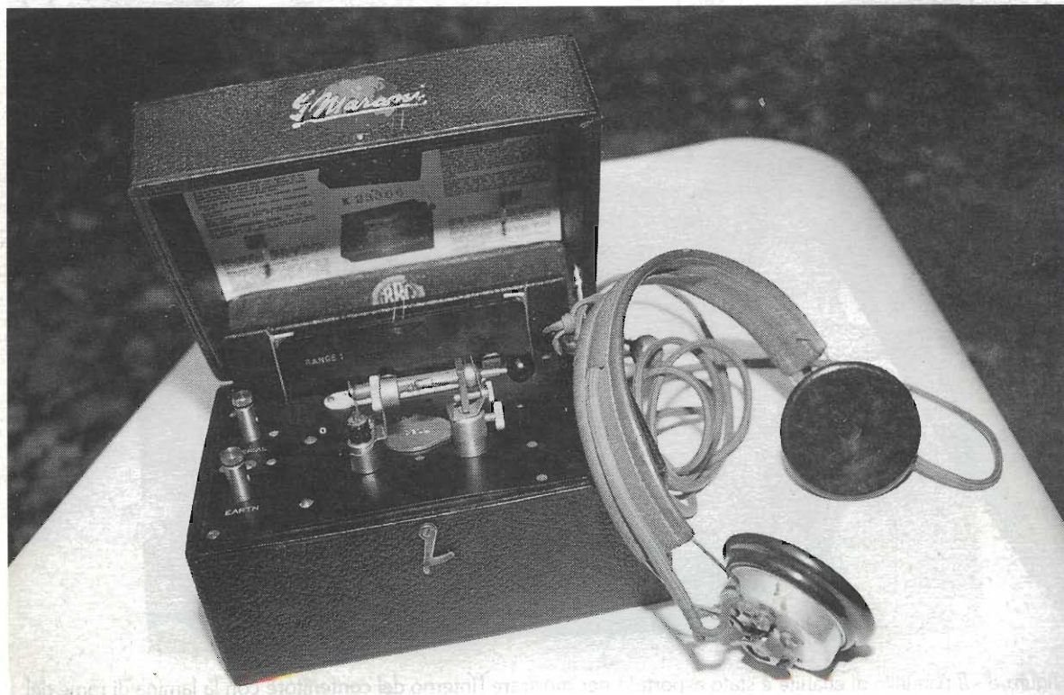
figura 1 - Ricevitore Crystal Junior con la sua cuffia d'ascolto.
